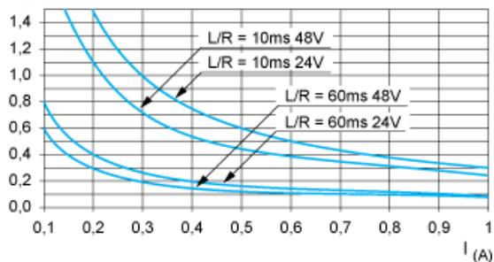
DC13conmutación electromagnética,  $L/R \leq 2 \times (U_e \times I_e)$  en ms,  $U_e$ : tensión nominal de funcionamiento,  $I_e$ : corriente nominal de funcionamiento (con diodo de protección en la carga, las curvas DC12 deben utilizarse con un coeficiente de 0,9 aplicado al número en millones de ciclos de funcionamiento)
