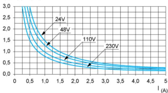
AC12 control de cargas resistivas y de cargas de estado sólido aisladas por optoacoplador,  $\cos \phi \geq 0,9$ .
