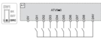
Conmutador fijado en posición SRC (Source) y uso de una alimentación externa para las entradas digitales
