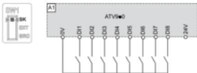
Conmutador fijado en posición EXT con alimentación externa para las entradas digitales
