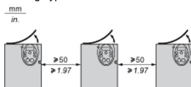
Wenn Sie die Schutzabdeckung von der Oberseite des Antriebs entfernen, wird die Schutzart IP21 für den Antrieb gewährleistet. Je nach Antriebsmodell kann die Schutzabdeckung unterschiedlich ausfallen (siehe nebenstehend).
