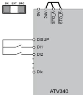
In der Position SRC gibt DISUP 24 V aus. In der Position SK ist DISUP an 0 V angeschlossen.
