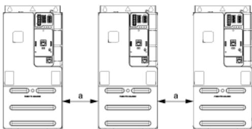
$a \geq 50$  mm (1,97 in.) von 50 bis 60 °C, keine Beschränkung unter 50 °C
