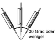
Bei der Montage einer Schalttafel in schräger Position mit einer Neigung von mehr als 30° darf die Umgebungstemperatur 40°C (104°F) nicht übersteigen. Gegebenenfalls müssen Sie eine Gebläseluftkühlung (Ventilator, Klimaanlage) einsetzen, damit eine Umgebungsbetriebstemperatur von höchstens 40°C (104 F) gewährleistet ist.
