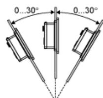
Bei Montage dieses Produkts in schräger Position mit einer Neigung von mehr als 30° darf die Umgebungstemperatur nicht höher sein als 40 °C (104 °F). Gegebenenfalls müssen Sie eine Gebläseluftkühlung (Ventilator, Klimaanlage) einsetzen, damit eine Umgebungsbetriebstemperatur von höchstens 40 °C (104 °F) gewährleistet ist.
