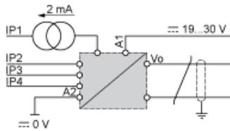
Die Eingangs-, Ausgangs- und Spannungsversorgungsleitungen müssen separat von den Netzkabeln verlegt werden, um unerwünschte Auswirkungen aufgrund induzierter Störspannungen zu vermeiden.
