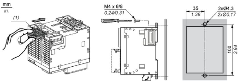
(1) Montieren eines Montagebandes
