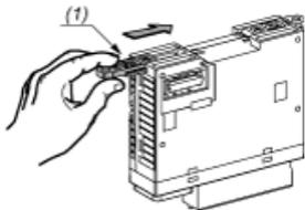
(1) Montieren eines Montagebandes
