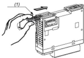
(1) Montieren eines Montagebandes
