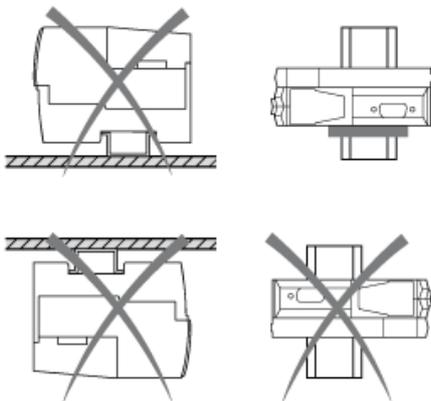
Montage auf einer DIN-Schiene
