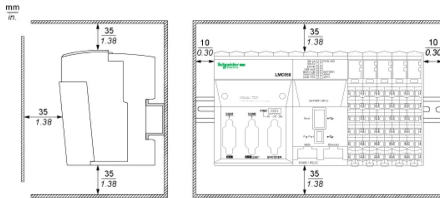
Montage auf einer DIN-Schiene
