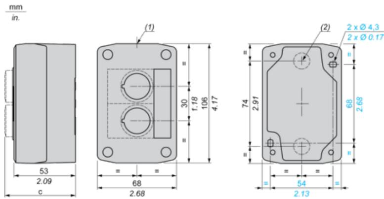
(1) 2 Ausbrüche für Kabelverschraubung Pg 13.5, Klemmkapazität 12 mm/0,47 in.
