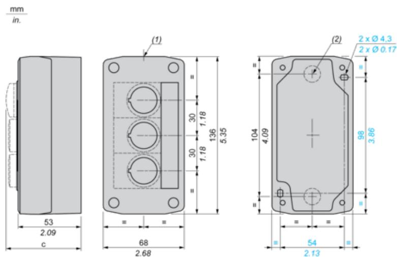
(1) 2 Ausbrüche für Kabelverschraubung Pg 13.5, Klemmkapazität 12 mm/0,47 in.
