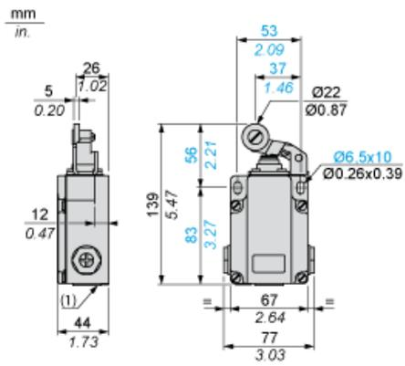
(1) 3 Gewindedurchführungen für Kabelverschraubung Pg 13.5
