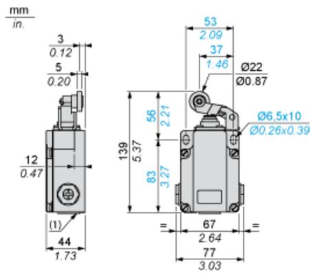
(1) 3 Gewindedurchführungen für Kabelverschraubung Pg 13.5
