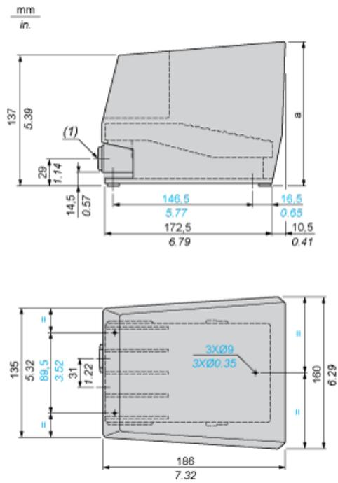
(1) 2 Gewindedurchführungen für Kabelverschraubung Nr. 16 (Pg 16). Für ISO M20 Adapter DE9RA620 verwenden.
