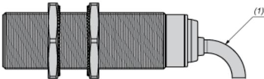
(1) Biegeradius des Kabels: 4 x externer Kabeldurchmesser
