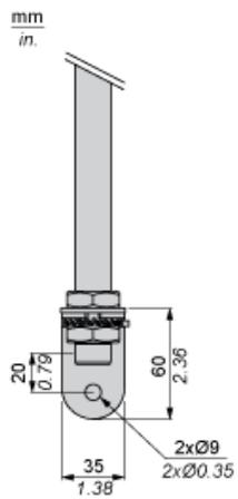
Montage einer modularen Signalsäule
