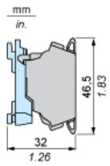
Mit ZB4BZ009 Befestigungsflansch
