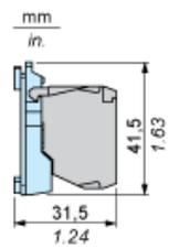
mit ZB4BZ009 Befestigungsflansch
