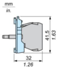
mit Befestigungsflansch ZB4BZ009
