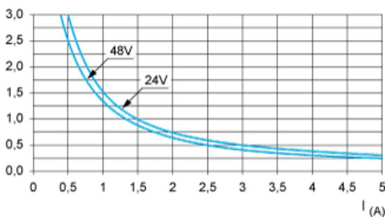
DC12 contrôle des charges résistives et des charges à état solide isolées par l'optocoupleur,  $I/R \leq 1 \text{ ms}$ .
