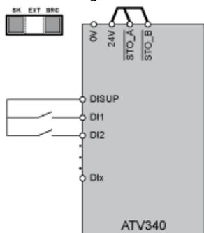
En position SRC, sorties DISUP 24 V. En position SK, DISUP est raccordé au 0 V.
