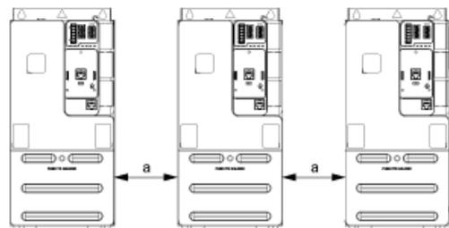
a ≥ 50 mm (1.97 po) de 50 à 60 °C, aucune restriction en-dessous de 50 °C
