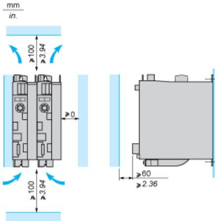
Les servo variateurs LXM32•U45M2, •U90M2 and LXM32•U60N4 sont refroidis par convection naturelle. Les servo variateurs LXM32•D18M2, •D30M2, LXM32 •D12N4, •D18N4, •D30N4 et •D72N4 possèdent un ventilateur intégré.
