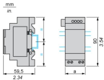
Fixation par vis (pattes de fixation rétractables)
