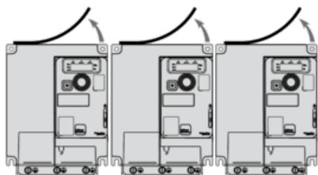
Montaggio tipo C: singolo, coperchio ventilazione rimosso
