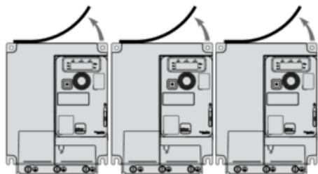
Montaggio tipo C: singolo, coperchio ventilazione rimosso
