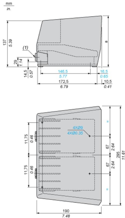
(1) 2 ingressi con foro filettato per passacavo n. 16 (Pg 16). Per ISO M20, utilizzare l'adattatore DE9RA620.
