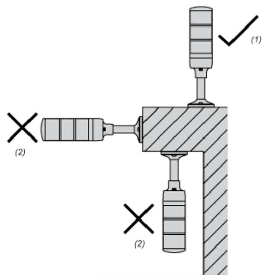
Per l'installazione, scegliere una superficie piana sufficientemente robusta con poche vibrazioni. Montare questo prodotto in base all'illustrazione per mantenere le caratteristiche IP.
