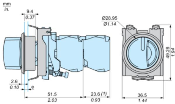
e: Spessore fissaggio: da 1,2 a 2,8 mm / da 0,05 a 0,11 in.
